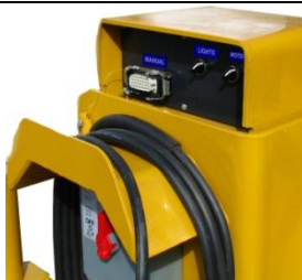
DESCONECTADOR ELÉCTRICO Y PANEL PRINCIPAL
