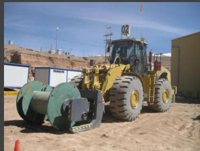
El MT EC para serie WL Cargador Frontal provee una buena visibilidad, resistente a las fuerzas de la máquina, bajo consumo hidráulico, controles en cabina de tipo proporcional, giro controlado de rotación y alto torque.
