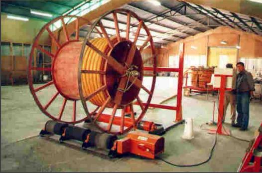
Sistemas de Enrolladores y Bobinadores de Carretes para Taller de Reparación de Cables, que permiten bobinar en ambos sentidos, rotación controlada para observar daños, hacer pruebas eléctricas y transferir cable desde carretes de madera a carretes de operación.
