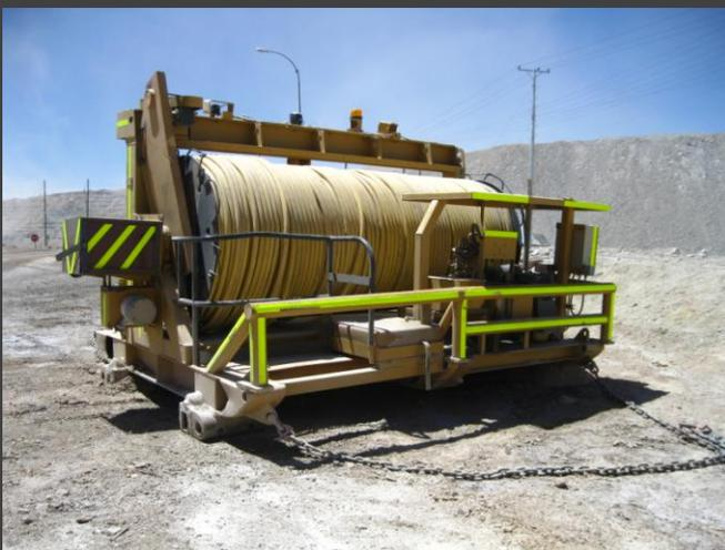
Este tipo de Enrollador de Cable requiere una unidad de remolque, como por ejemplo un Wheel Dozer.
