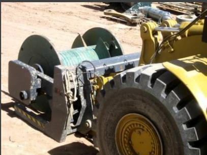
Los Enrolladores de esta serie, requieren mínima mantención, son fabricados de acero estructural y operan carretes livianos y resistentes. El diámetro interno del carrete respeta el radio mínimo de plegado del cable.
