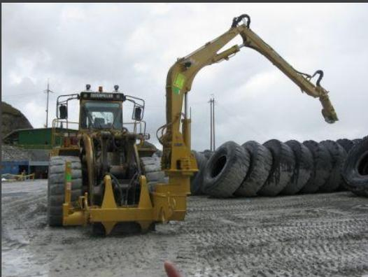
Brazo adicional para Enrolladores de la serie EC-500, que permiten manipular el cable tanto al enrollar como al salir. Este aditamento es comandado desde la cabina del Cargador o Wheel dozer y permite colocar el cable donde se le necesita.
