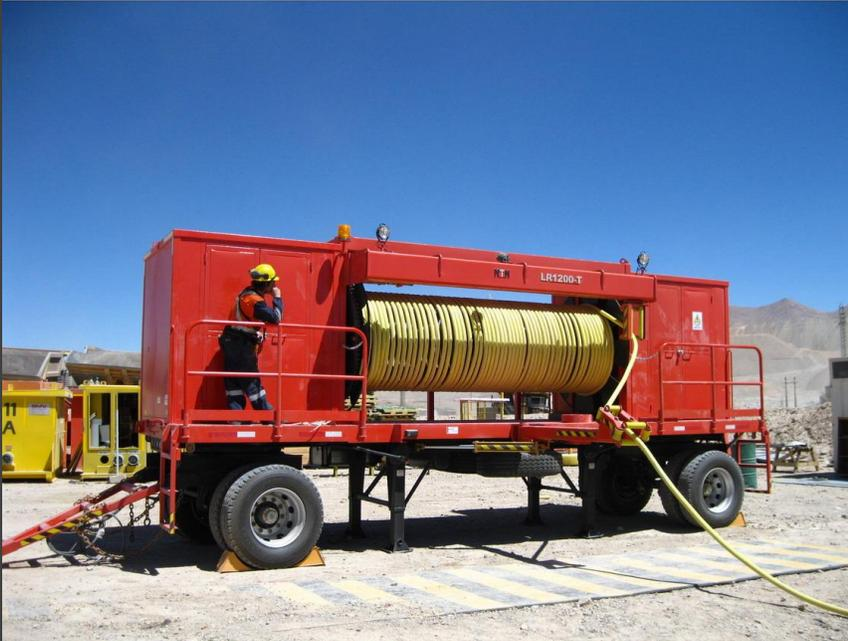
Enrolladores de Cable Energizado para alimentar una Pala o Perforadora en sus traslados.
