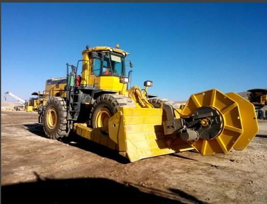
El control en la cabina de la máquina ofrece un manejo del carrete suave y proporcional. Se puede hacer girar el carrete en ambas direcciones (FWD/REV) Y recoger cable desde una distancia de hasta 50 m.
