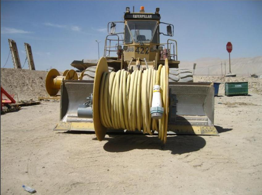
Enrolladores de Cable para Tractor de Neumáticos (Wheel Dozer):
