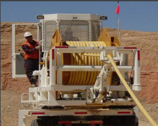
Desde la cabina, el operador puede realizar todos los movimientos necesarios para recoger y bobinar el cable en el carrete. Utiliza un Brazo Manipulador del cable que le permite colocarlo sobre la berma o al costado y a la vez recogerlo.
