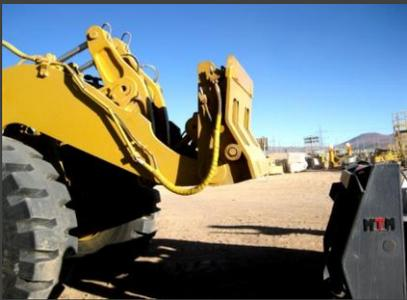
Sistema de montaje al Cargador mediante **Porta Herramienta WL-KAT** de montaje y desacople rápido, permitiendo intercambio de Balde, Enrollador, Horquillas u otros implementos. El operador no se baja del Cargador..!!
